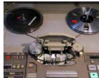
デッキヘッド回り (整備のため開放した状態)
