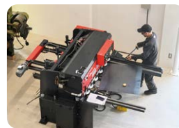
シャーリング(共有工房)
